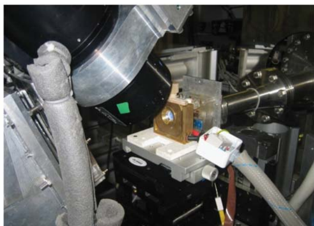
Hình 4. Thiết lập thí nghiệm đo phổ hấp thụ in-situ XRD/XAS tại phòng thí nghiệm BM26 SRS Lab - Grenoble, Pháp: vị trí Detector (trái) và bộ điều khiển nhiệt độ (phải)
