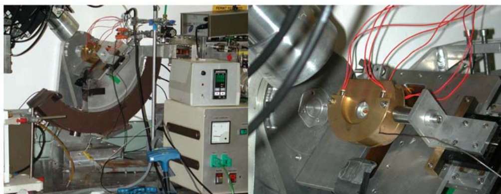
Hình 2. Thiết lập thí nghiệm đo phổ hấp thụ in-situ XRD/XAS (phải) và Cell phản ứng (trái) tại Phòng thí nghiệm Daresbury Lab, station 9.3, Warrington, Vương quốc Anh
